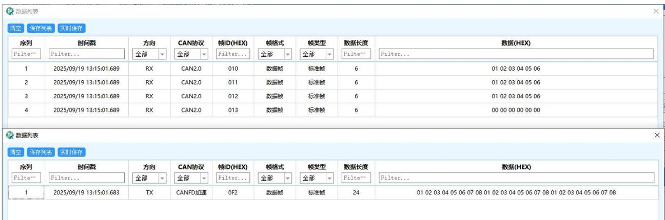
图 35 24 字节 CANFD 拆分为 4 个 6 字节 CAN 示例
