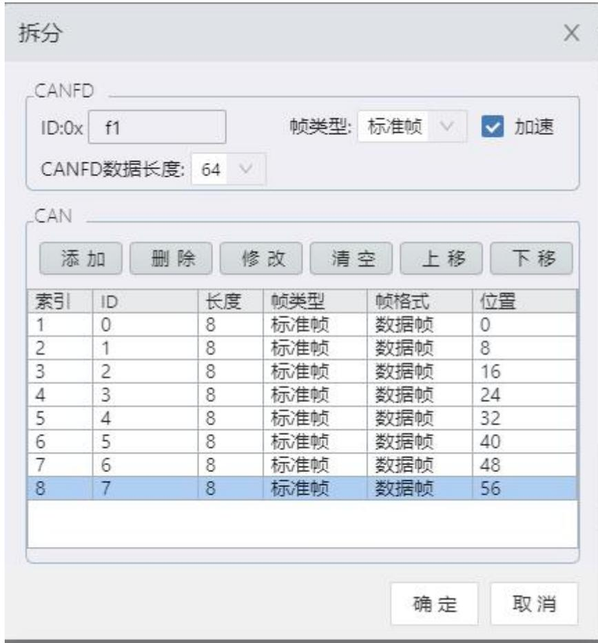
图 32 64 字节 CANFD 拆分 8 个 8 字节 CAN 设置
