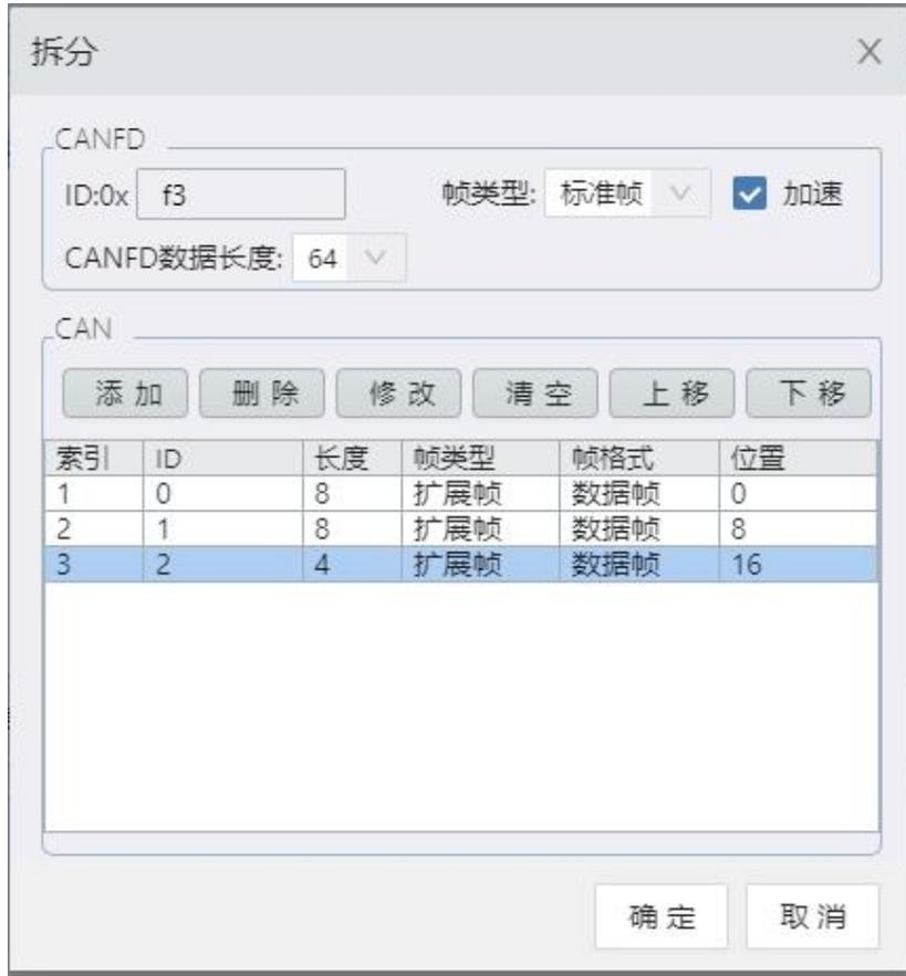
图 36 64 字节 CANFD 拆分为 2 个 8 字节 CAN 设置
