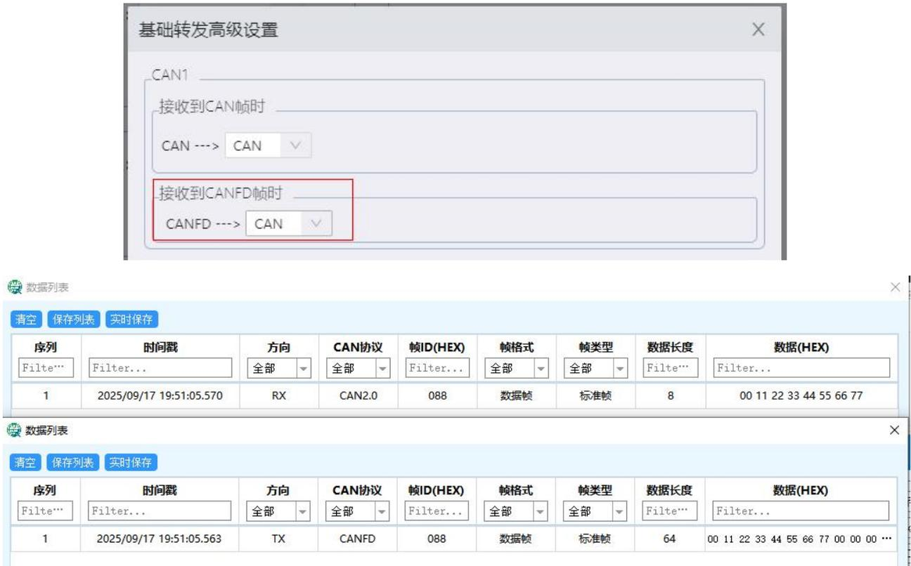
图 14 CANFD 转 CAN 示例 (DLC 大于 8)
